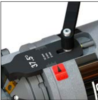
Putken pysäyttimen säätö: asteikko putken seinämän paksuuden mukaan terävän v-viisteen tekoon
